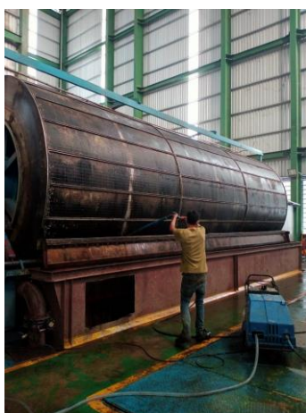
รูปที่ 35 การทำความสะอาดหม้อกรองน้ำย่อย
